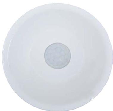
该探测器整合了 PYROFLEX™ 红外传感器和先进的 SureSpot™ 微处理系统，可有效防止误报，特有实时自监控功能，探测器精度更加准确，设备更加稳定，并特有 122 视区透镜/探测系统。动作亮度和延迟时间可调，灵敏度自适应。采用干接点信号连接，需要接入 AT-NET 感应管理器，适用于楼道/卫生间/出入口等公共区域。
