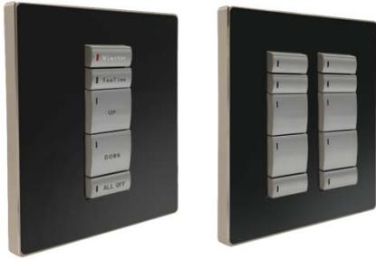
可编程按键面板，客户可自定按键数量（3-7 个或 6-14 个），输入电源为弱电，按键可自定义标志、文字和图案，多种颜色的拉丝铝边框面板及玻璃面板高雅而又尊贵，每个按键都有独特的状态反馈指示灯，可通过编程自定义每个按键的控制功能，设备 ID 号可通过拨码开关设定，标准 86 式墙身底盒安装方式，安装拆卸方便。
