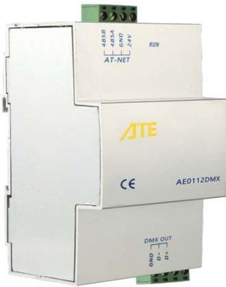
DMX512 接口是 AT-Net 系统拓展应用的转换器件。通过它可以把 DMX512 协议的网络联入 AT-Net 系统进行控制，实现 DMX512 系统与 AT-Net 系统间信息的交换和数据共享。该模块为满足 AT-Net 系统使用需要的简化 DMX512 协议控制。其输出 DMX512 通道数量有限，且在控制功能上也是采用单通道的 DMX512 数值变化实现简单的灯光亮度、效果控制。设备自带运行状态指示灯，方便直观了解设备实时状况。采用铝合金外壳，美观而坚固。插拔式接线端子，接线十分简便快速。
