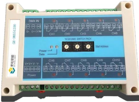
接收国际标准 DMX512 信号，10 通道开关量输出，每通道输出电流高达 3 安培。每通道输出端子均带 LED 指示灯、三个接点：常开、常闭、公共干接点。国内首创采用旋转开关设置 DMX512 起始地址，避免以往采用二进制拨码方式设置 DMX512 起始地址所带来的换算困难，容易错拨，识别困难等一系列弊端。DMX512 写址器设置起始地址和旋转开关设置起始地址任意选择。
