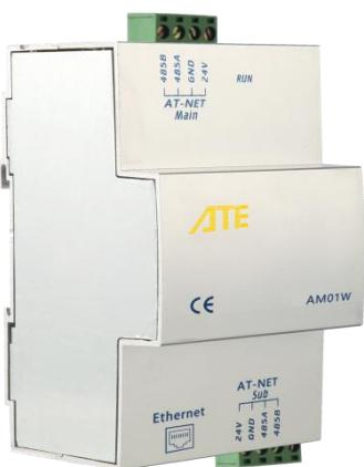
可编程标准 DIN 导轨式控制主机，固态模块化设计，接线采用高可靠的插拔式接线端子，使得其非常易于工程安装与维护。内置高性能快速的嵌入式 FLASH 存储器对系统网络通信数据的流畅交换和处理，以及强大的逻辑指令执行功能。AT-NET 总线通信接口可连接 64 个节点设备于一个子网，其开放式标准 RS485 协议端口可连接 PC 或其它第三方设备，轻松实现系统对接。Ethernet TCP/IP 网口可连接网络路由器构建以太网进行系统控制。设备自带运行状态指示灯，方便直观了解设备实时状况。采用铝合金外壳，美观而坚固。插拔式接线端子，接线十分简便快速。
