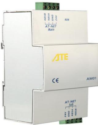
可编程标准 DIN 导轨式控制主机，固态模块化设计，接线采用高可靠的插拔式接线端子，使得其非常易于工程安装与维护。内置高性能快速的嵌入式 FLASH 存储器对系统网络通信数据的流畅交换和处理，以及强大的逻辑指令执行功能。AT-NET 总线通信接口可连接 64 个节点设备于一个子网，其开放式标准 RS485 协议端口可连接 PC 或其它第三方设备，轻松实现系统对接。设备自带运行状态指示灯，方便直观了解设备实时状况。采用铝合金外壳，美观而坚固。插拔式接线端子，接线十分简便快速。
