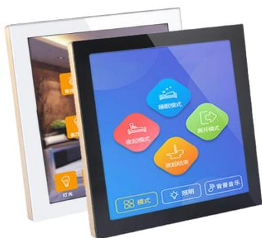
4寸TFT彩色全触屏控制；采用ARM处理芯片，支持多任务进程，功能强大，内置时钟功能；配备界面编程软件和控制编程软件，可自由编写和更换显示界面及操作功能，图形界面支持图片、图形、文字、按键；界面工程和控制程序存在芯片内，通过USB跟电脑对接进行功能升级；在进行控制程序功能升级时，可直接在原文件上进行增加，删减和修改，简单易用；标准86式墙身底盒安装方式，安装拆卸方便。
