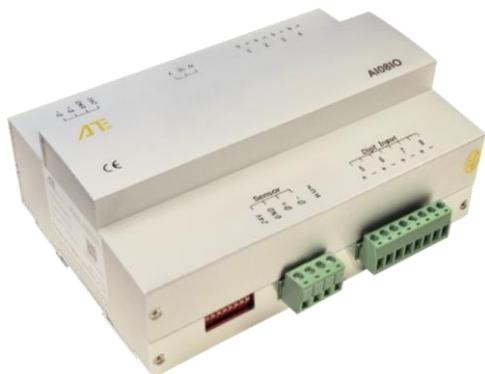
AI08IO 为 AT-NET 系统总线管理器，具备 8 路 GPI 通用干接口信号输入，可用于连接传感器或其它开关量信号的接入总线，实现照明场景、调光、定时等功能控制。每路干接点输入信号可通过编程独立自定义控制功能。另外设备预留有对外 RS485 接口，同时可对外部接入设备提供 DC24V 工作电源。
